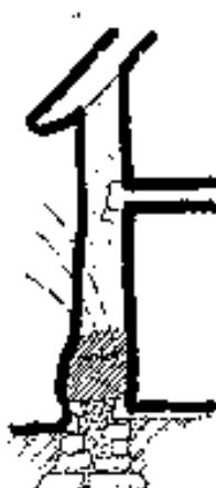
FIGURA 6 : EFEITOS DO EXCESSO DE HUMIDADE NAS PAREDES EM TERRA
