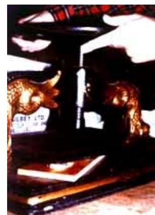
Esta imagem mostra o processo de compressão ou prensagem da “ compo ” num molde usando-se uma prensa de parafuso. Photo: Jonathan Thornton.
