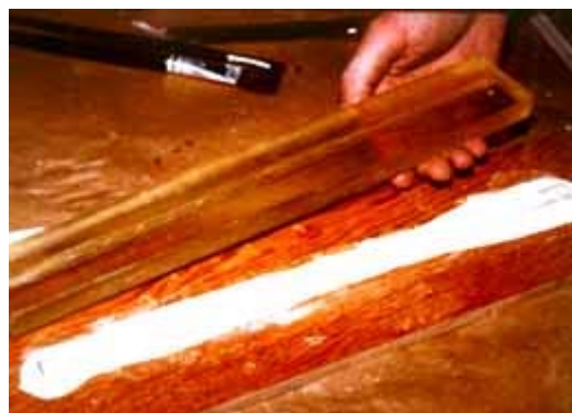
Este troço acabado de um molde em compo está colado na sua tábua de prensagem. A peça acabada de fazer vai ser recortada da tábua e depois aplicada.
