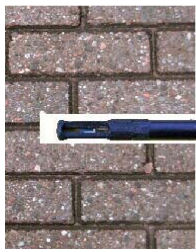
Ensaio com um higrómetro para a medição da ERH
