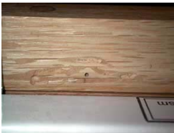
SUPERFÍCIE APLAINADA MOSTRANDO A PRESENÇA DE DANOS ANTERIORES AO CORTE DA MADEIRA
