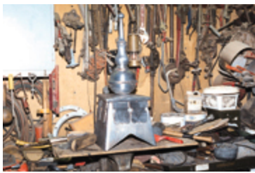
Trabalho em execução num terminal de chumbo fundido na oficina de Terry Fillary
