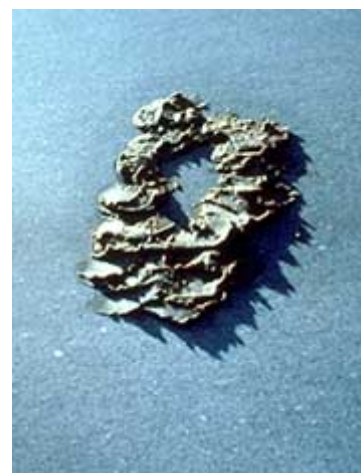
Um emplastro é frequentemente o método de limpeza preferível. Fotografia : Arquivos do NPS.
