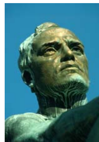
Fig. 17 – Memorial de Samuel Gompers , de Robert I Aitkens, 1933, Washington, DC. Pomenor dos estragos na superfície provocados pela limpeza abrasiva, 1987. (Montagna)
